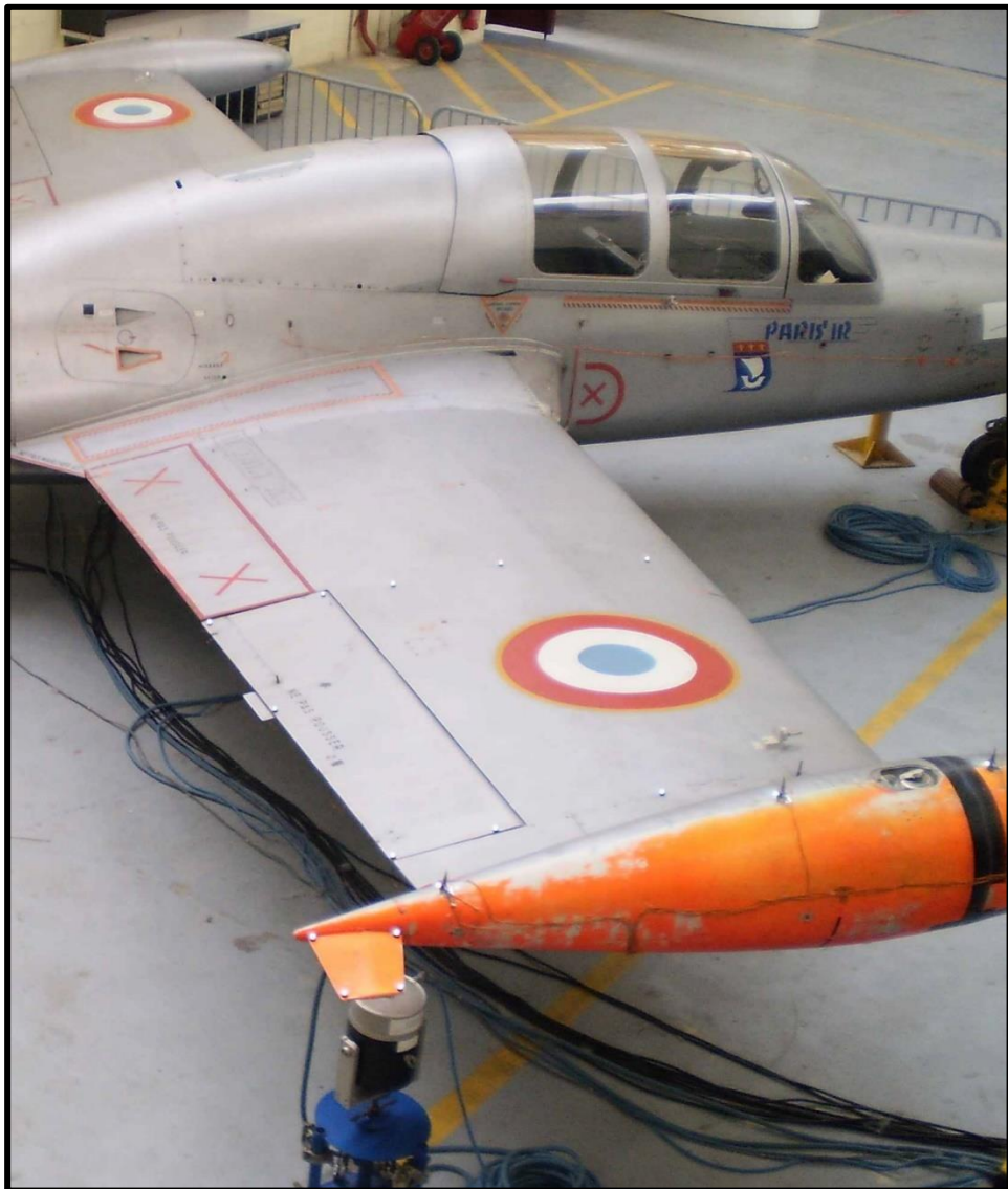
Figure 2 : Morane Saulnier MS760 PARIS avec des sphères réfléchissantes et des accéléromètres prêts pour des mesures par motion capture
